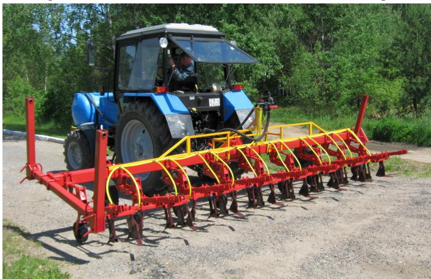
Предназначен для междурядной обработки 6-ти рядных посевов кукурузы, подсолнечника, клещевины и других пропашных культур, высейных с междурядьем 600, 700, 900 мм.
