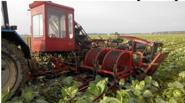
Малогабаритный капустоуборочный комбайн МКК предназначен для уборки белокочанной капусты твёрдых сортов размером от 10 до 35см в диаметре, высаженной с междурядьем 70-75 см, и погрузкой в транспортные средства, движущиеся параллельно комбайну.
